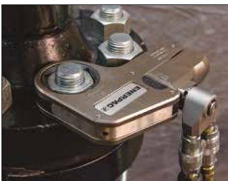
◀ Hydraulik-Drehmomentschlüssel jeder beliebigen Marke können mit den tragbaren Drehmomentpumpen der ZU4T-Serie betrieben werden
