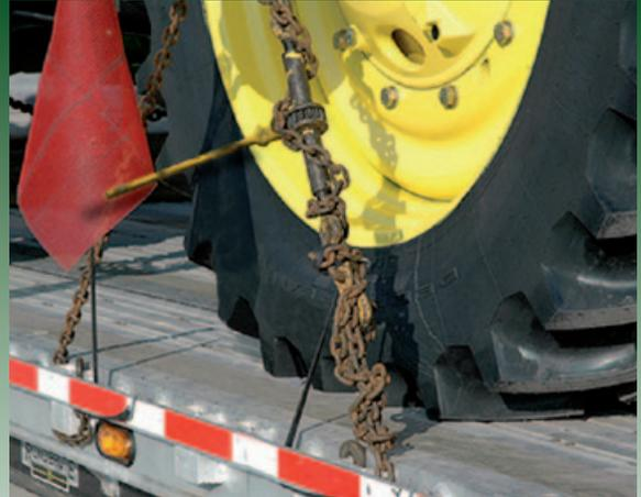
Der Ratschen-Lastspanner der SER-Serie wurde hier eingesetzt, um einen Traktor auf dem Transport zu sichern. Dank seiner Schwerlast-Stahlkonstruktion eignet sich dieser Lastspanner für unzählige Anwendungen.
