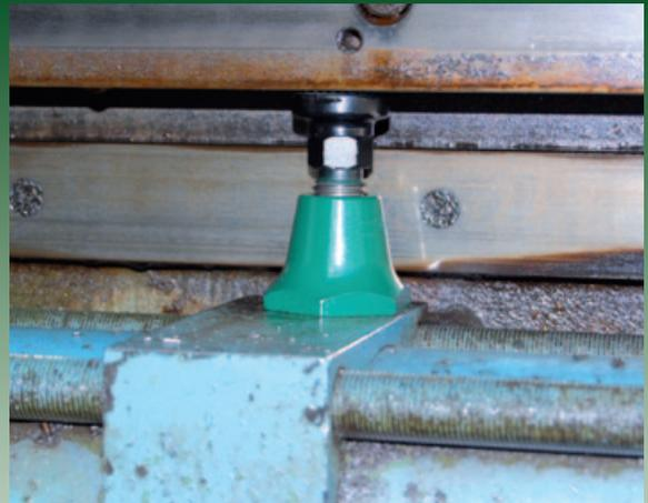
Der S3A mit seinem flachen Design und der kleinen Auflagefläche war die perfekte Lösung, um den Unterbau dieser Fräsmaschine zu nivellieren.
