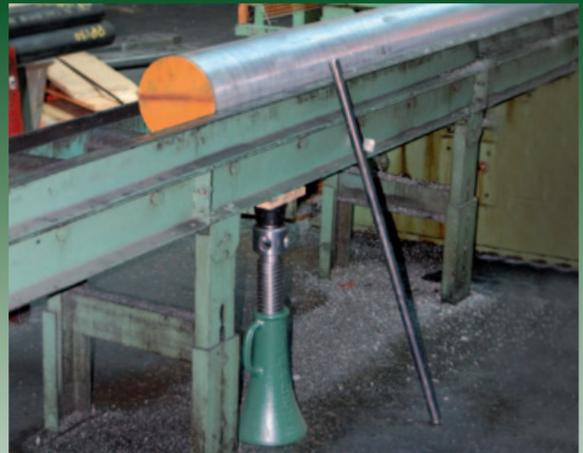
Simplex Schraubwinden passen die Höhe dieser Walzen-Einspannvorrichtung an. "Wir verwenden diese Einspannvorrichtung beim Schneiden langer Stücke."
