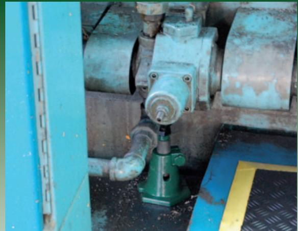
Mit ihrer gezackten Auflagefläche und der drehbaren Inbusschraube sind die vielseitigen hydraulischen Heber von Simplex die perfekte Wahl zum Nivellieren oder für Reparatur- & Wartungsarbeiten am Unterbau von Maschinen oder Motoren.
