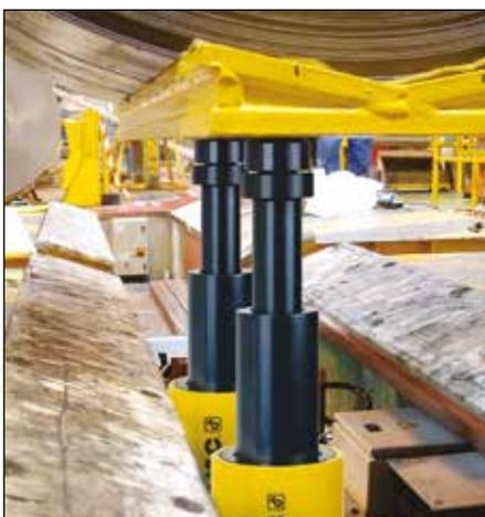
◀ Die größere Hublänge der Teleskopzylinder spart Zeit und vereinfacht Aufgaben, bei denen Lasten über eine größere Entfernung bewegt werden müssen, sodass keine provisorischen Abstützvorrichtungen erforderlich sind.
