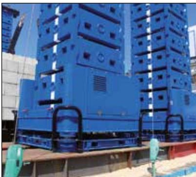
▼ JS125 Jack-Up Stufenhubsystem auf einem Grundrahmenwagen.
