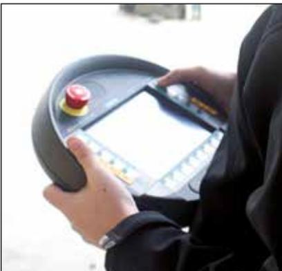
▼ Verankerungsspezialisten setzen das SyncHoist-System ein, um bei der Positionierung eines 1140 t schweren Moduls eines Kernkraftwerks jeden Hubpunkt separat oder zusammen synchronisiert präzise einzustellen und zu überwachen.
