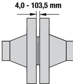
Ein innovativer Flanschspreizkeil für den Einsatz an kleinen, mittleren oder großen Flanschverbindungen mit einem minimalen Zugangsspalt von 4 mm. Das SWi-Programm umfasst ATEX-zugelassene Optionen.
