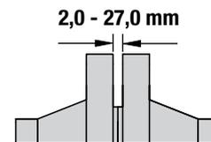
Ein mechanisches Werkzeug für Niederdruck-Flansche mit kleinem Durchmesser und einem minimalen Zugangsspalt von 2 mm.
