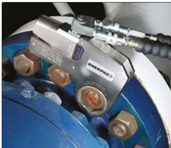
◀ Le centraline serie ZE4T per chiavi dinamometriche si adattano perfettamente alla chiave W2000X.
