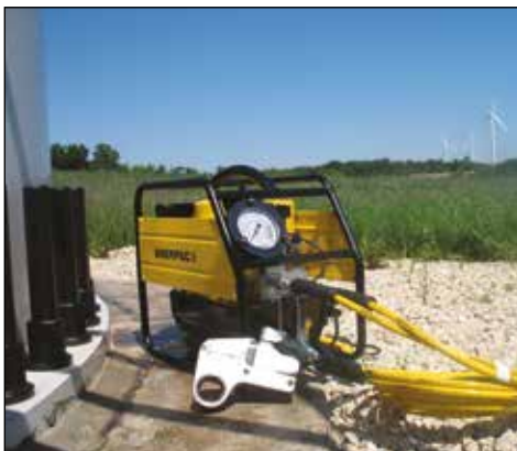
La centralina TQ700E e le chiavi della serie W rappresentano una combinazione adatta alle applicazioni del settore eolico.
