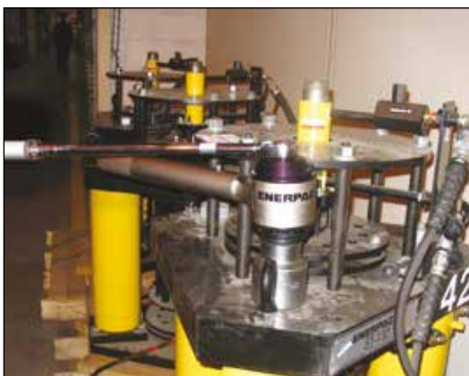
◀ Multiplicateur de couple Enerpac E393 avec barre de réaction, utilisé pour serrer des boulons avec un couple pouvant atteindre 4300 Nm.
