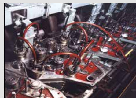
▲ Écrous hydrauliques sur moteur diesel
