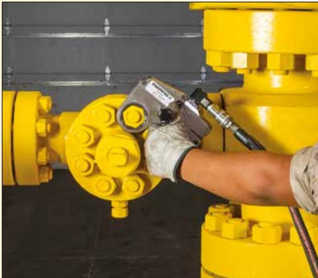
**Clé dynamométrique à profil étroit W4000X sur une bride de tuyauterie API**
