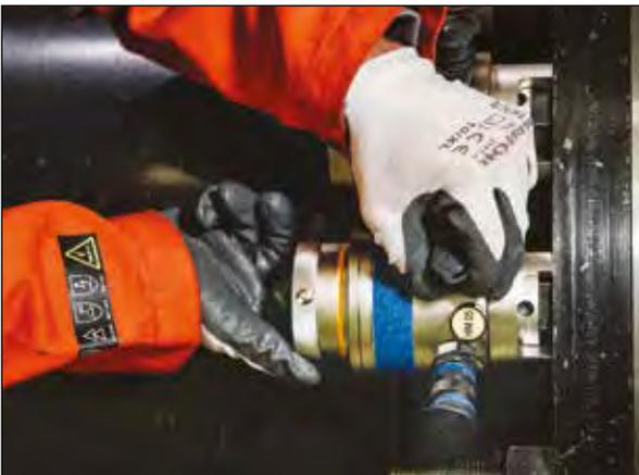
◀ Les tendeurs HydraMax® série HM d'Enerpac ont été conçus pour produire des charges de boulons élevées sur des brides compactes, tout en offrant une grande polyvalence pour fonctionner sur un maximum de boulons.
