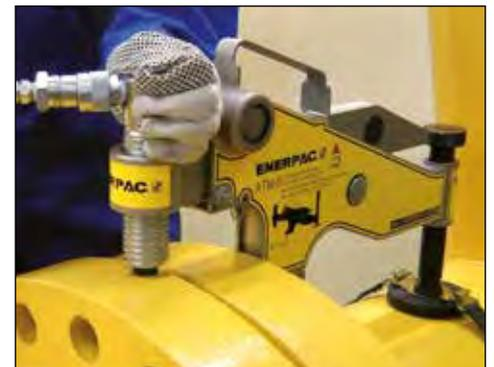
▼ FSC-14, FSM-8 et FSH-14 avec SB-1 cale de sécurité
