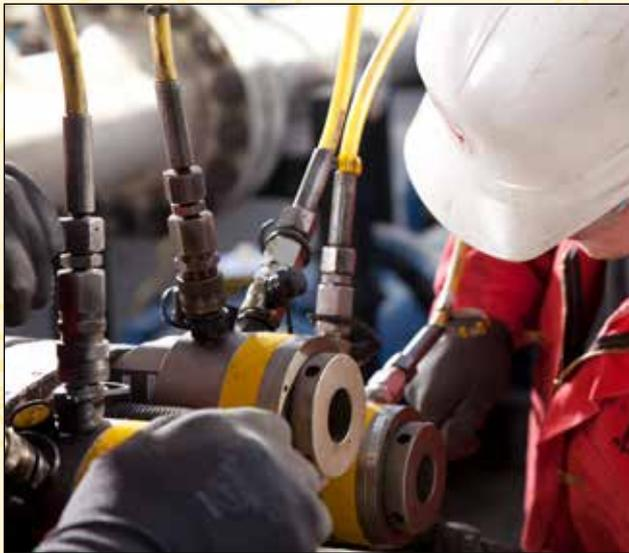
**Tendeurs compacts HydraMax® : une mise en tension sûre, fiable et reproductible garantissant l'intégrité des joints**
