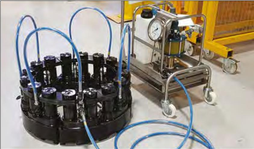
▲ Installation de la mise en tension multigoujon.
