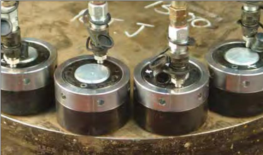
▲ Tensionamento con dadi idraulici.
