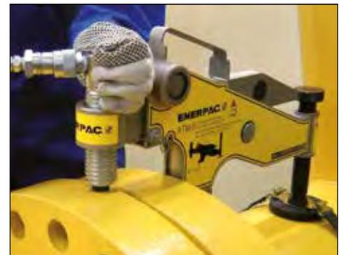
▼ FSC-14, FSM-8 e FSH-14 con blocchi di sicurezza SB-1
