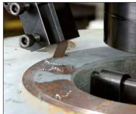
La gamma di divaricatori brevettati Equalizer™ per le flange è stata sviluppata per semplificare la manutenzione dei giunti flangiati. Non occorrerà più servirsi di funi e pulegge, cricchetti, estrattori, chiavi di estrazione o martelli, poiché esiste un'alternativa sicura, rapida ed efficace: la gamma di divaricatori Equalizer™.
