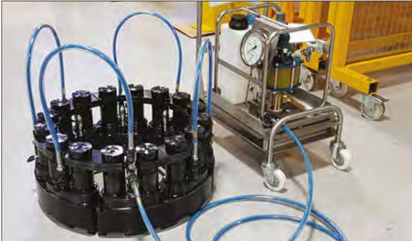
▲ Allestimento per il tensionamento di più bulloni.
