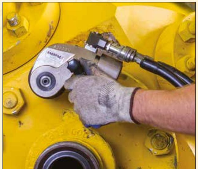
▼ Unità di azionamento RSL con portainseri intercambiabili RLP esagono passante e RSQ attacco quadro
