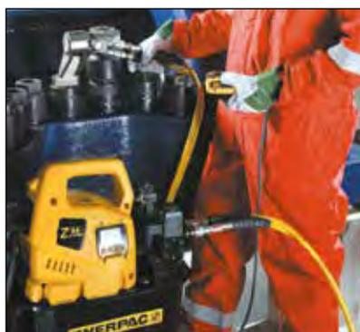
◀ Le pompe portatili della serie ZU4T per chiavi dinamometriche possono azionare chiavi dinamometriche idrauliche di qualsiasi marca.
