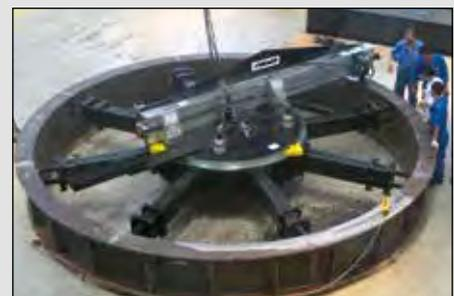
▲ Fresatrici circolari utilizzate nella cantieristica navale e nel settore della produzione di energia elettrica.
