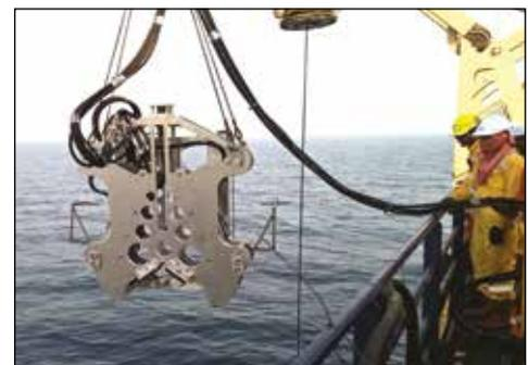
▲ Ins Meer abgesenkte MDWS-Diamantkettensäge.
