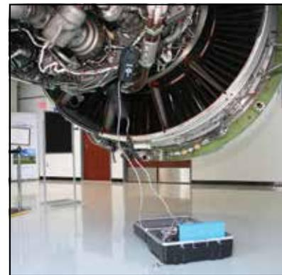
DTT-Motor auf einem Getriebe installiert
