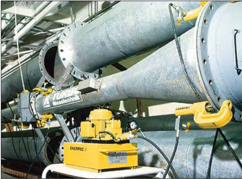
▲ Exemple d'utilisation d'une presse à col de cygne A-220.
